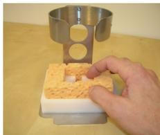
8. Gereinigten und gut ausgedrückten Schwamm wieder in die dafür vorgesehene Wanne des Duftflaschen-Moduls einsetzen.
