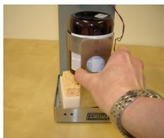
3. Duftflaschen-Modul mittels Anheben und Herausziehen vom Gerätfach entfernen.
