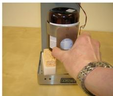
12. Neu aufgefülltes Duftflaschen-Modul so im Gerätfach platzieren, dass das Gewicht des Moduls die mechanische Füllstandsüberwachung herunterdrückt.
