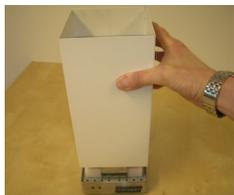
2. Gerätegehäuse nach oben von der Gehäusestruktur weziehen.
