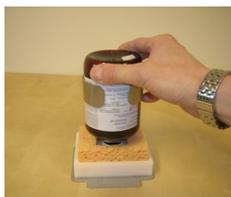
10. Neue Duftstoff-Flasche (450 ml) kopf voran in die dafür vorgesehene Halterung des Duftflaschen-Moduls einführen und Flasche bis zum Anschlag nach unten drücken, sodass die Feder den Verschluss öffnet und die Duftstoffmischung in die Wanne fließen kann.
